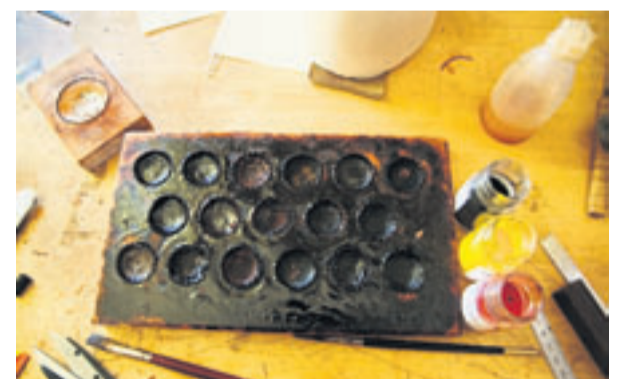
Die verschiedenen Lacke werden von Christoph Teichmann selbst angerührt. Als Schälchen dienen Bierdeckel.
